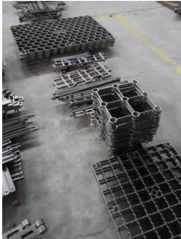
图 4 热处理零件工装
